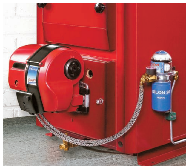
Laitteeseen sisältyy alipainemittari ja sulkuventtiili. Kun alipainemittarin osoitin on punaisella alueella, on suodatin vaihdettava.
